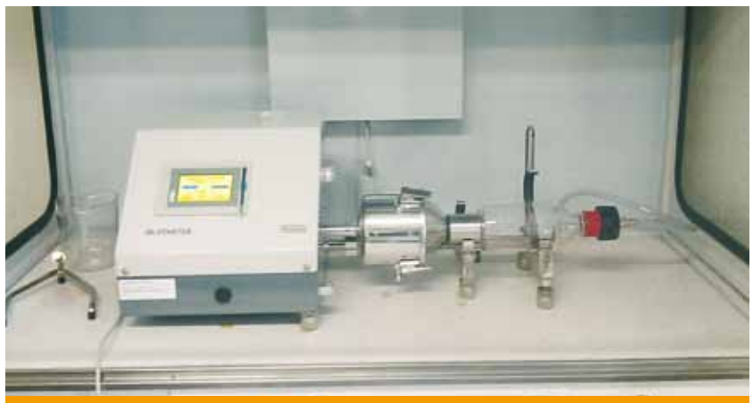
A BÁCS-ÁG Kft. laborjában működő Heubach pormérő
